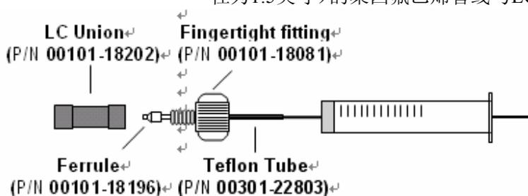
图3—1注射器的管线连接
